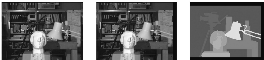
图 2-5 双目相机的数据：左眼图像，右眼图像。通过左右眼的差异，能够判断场景中物体离相机距离。
