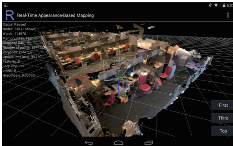
图 14-6 RTAB-MAP 在 Google Project Tango 上的运行样例。
